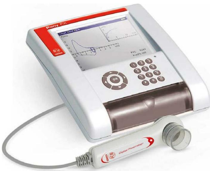
Lo spirometro **Pony FX** è uno strumento di nuova concezione, che si sviluppa seguendo le più recenti linee guida **ATS/ERS** per i produttori di spirometri.
