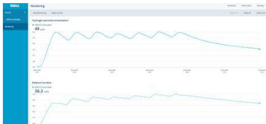
Sensori opzionali rilevano in tempo reale la concentrazione del principio attivo aerodisperso e l'umidità relativa, adattando il trattamento per garantire l'efficacia e la sicurezza del processo.
