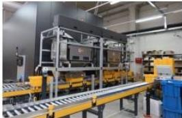
Braccio robotizzato per il prelievo della singola confezione: azzeramento del rischio di errore (lettura automatica di codice Minsan, lotto e scadenza) e automazione dell'allestimento della cassetta grazie al convogliatore
